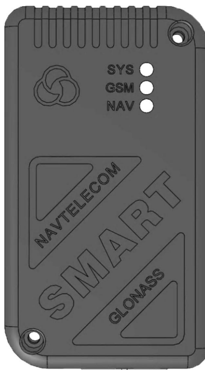
Рис. 7. Системный блок изделий СМАРТ (вид сверху). Индикаторы SYS, GSM, NAV
