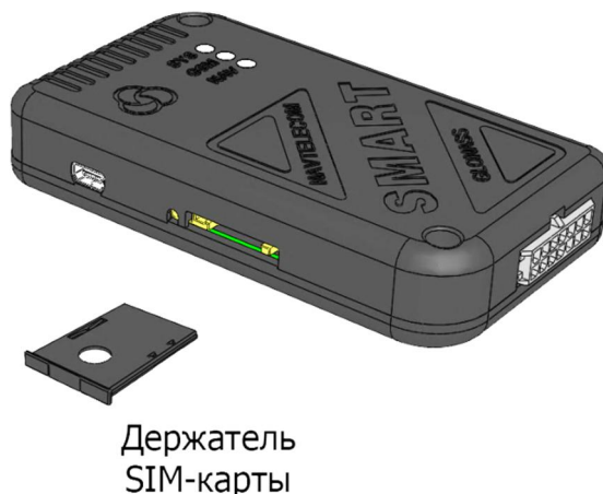
Рис. 45. Установка SIM-карты в устройство
