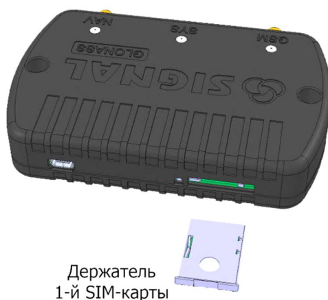
Рис. 41. Установка внешней SIM-карты в устройство
