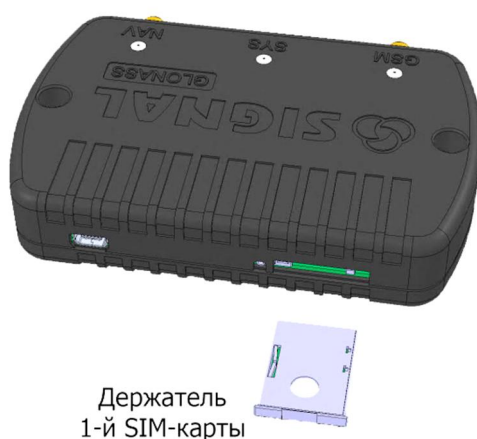
Рис. 41. Установка внешней SIM-карты в устройство
